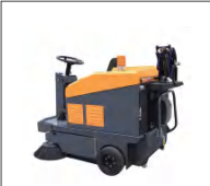
高压冲洗装置
